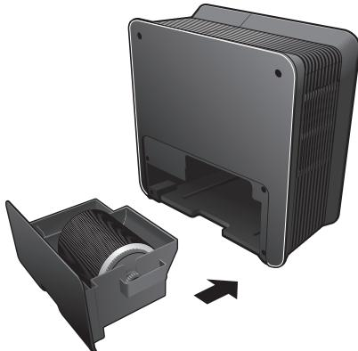
**⑧ Plaats de watertank weer in het apparaat en sluit de deksel**
