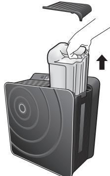
② Ziehen Sie den Wasserbassin aus dem Gerät
